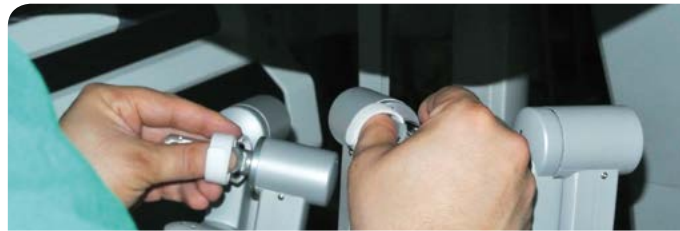
Master Controller für die Übertragung der Handbewegungen
