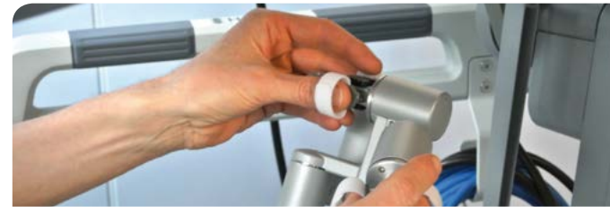
Master Controller für die Übertragung der Handbewegungen
