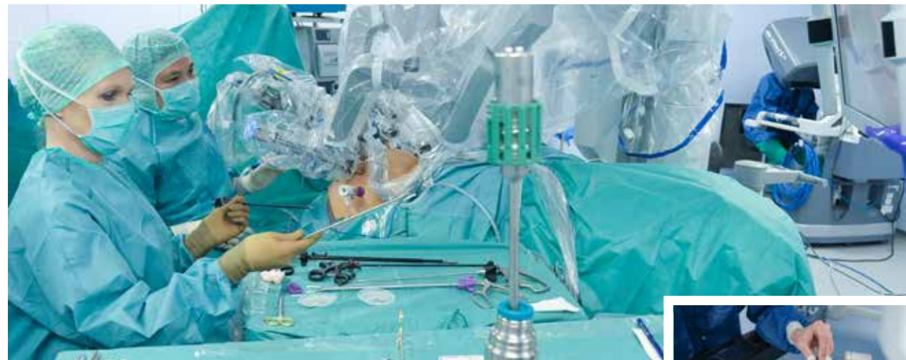
Roboterassistierte „da Vinci“-Operation in einem der neuen OP-Säle am Campus Kiel: Im Vordergrund der Patientenwagen, die mikrochirurgischen Instrumente wurden über kleinste Schnitte in den Körper des Patienten eingeführt. Sie sind an die in Schutzfolie eingehüllten Roboterarme angeschlossen. Hinten rechts der Chirurg an der Konsole: Von hier aus steuert er über zwei Bedienelemente für die Finger (kleines Bild) die Instrumente an den Roboterarmen.
