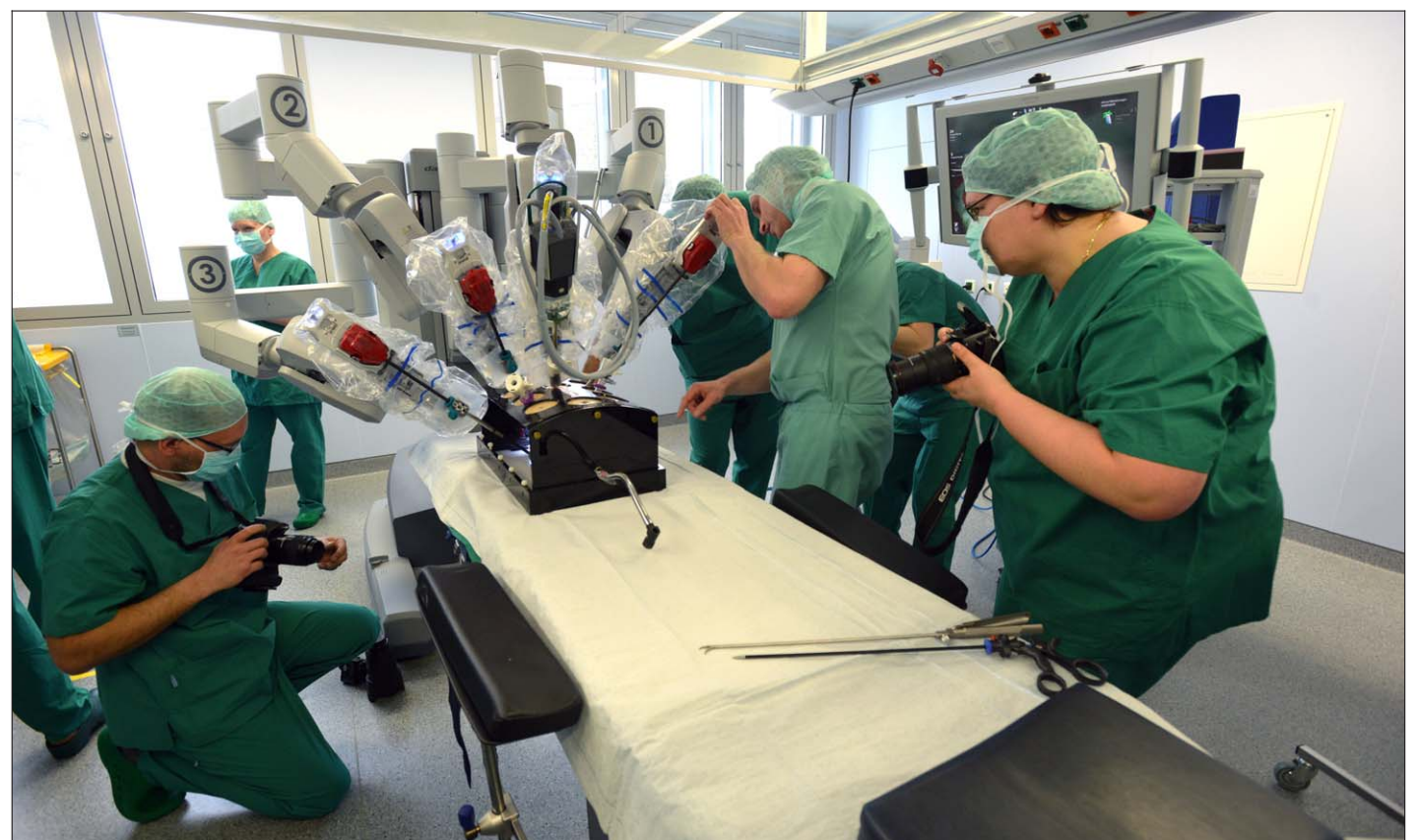
Im Blitzlichtgewitter: Der vierarmige Roboter „da Vinci Si“ führt am Körper des Patienten – hier durch den schwarzen Kasten dargestellt – exakt die Bewegungen aus, die der Chirurg an einer ein paar Meter entfernten Konsole vorgibt. Foto Eisenkrätzer
