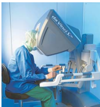
Von dieser Steuerkonsole aus dirigiert der Operateur (hier Jünemann) die Roboterarme.
