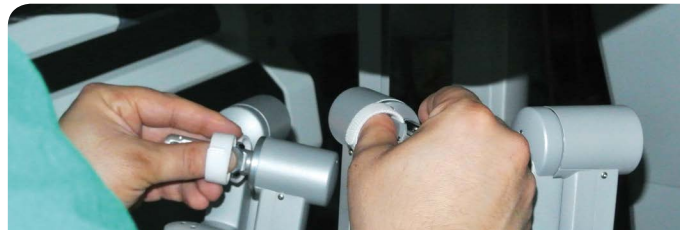
Master Controller für die Übertragung der Handbewegungen
