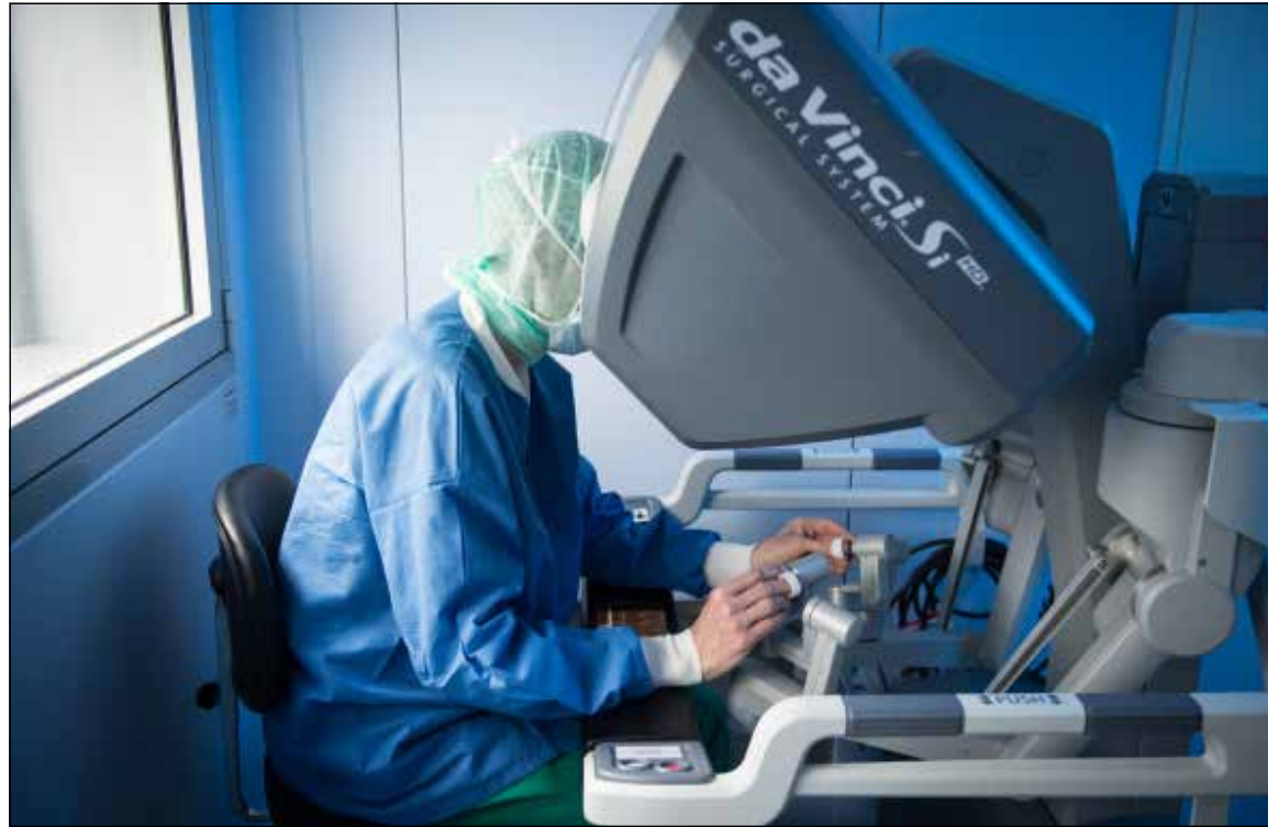
Der Chirurg operiert über die Konsole des da Vinci Si-Systems im Körper des Patienten.
