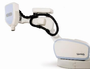
CyberKnife: Roboter für hochpräzise Bestrahlungen, kann Bewegungen (z.B. durch Atmung) erkennen und ausgleichen und ermöglicht Bestrahlung von winzigen Tumoren (nur an wenigen Kliniken verfügbar, u.a. am UKSH in Kiel).
