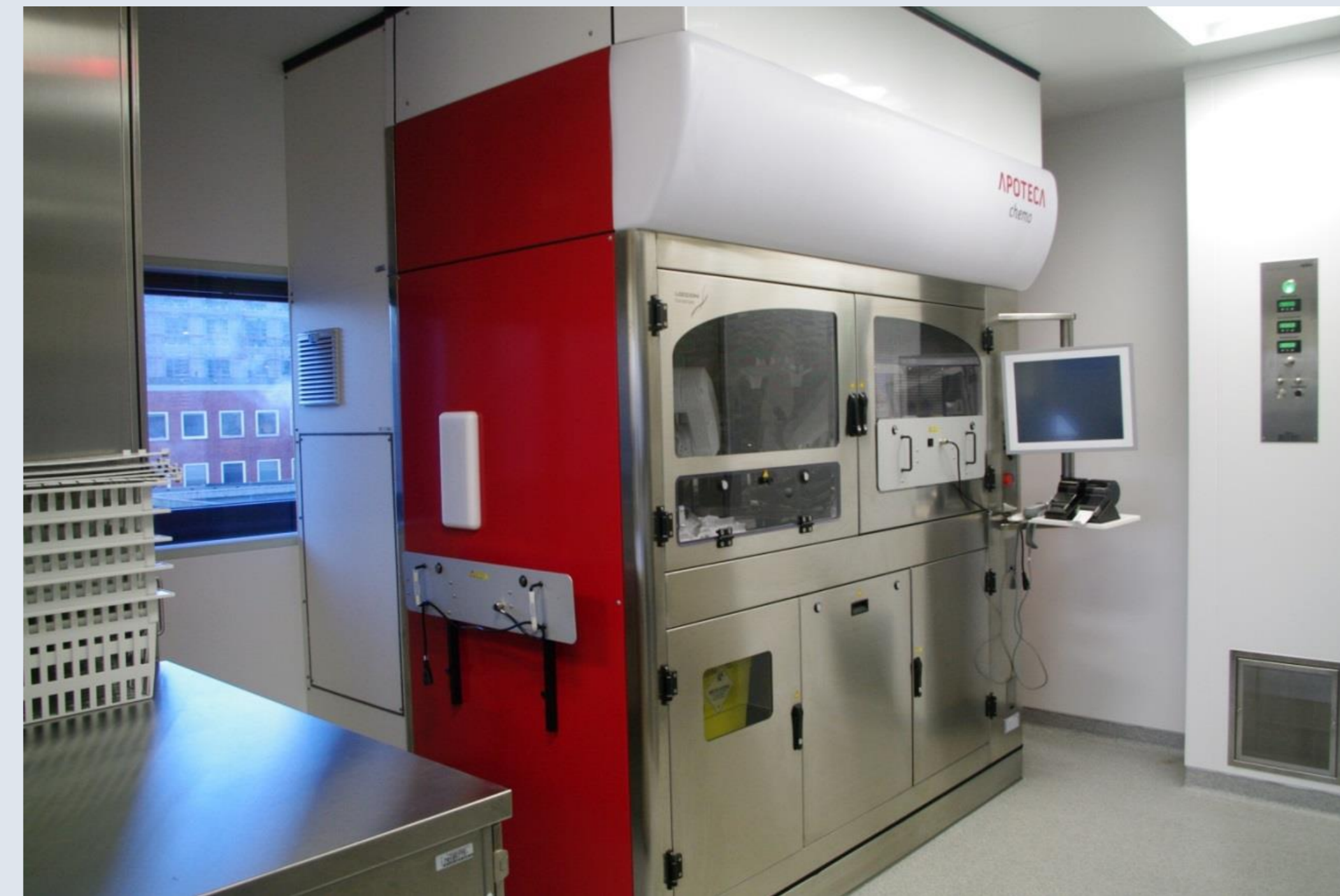
Abb. 1: APOTECaChemo im UKSH Kiel "A in B"; Der Roboter steht am Campus Kiel im Reinraum.
