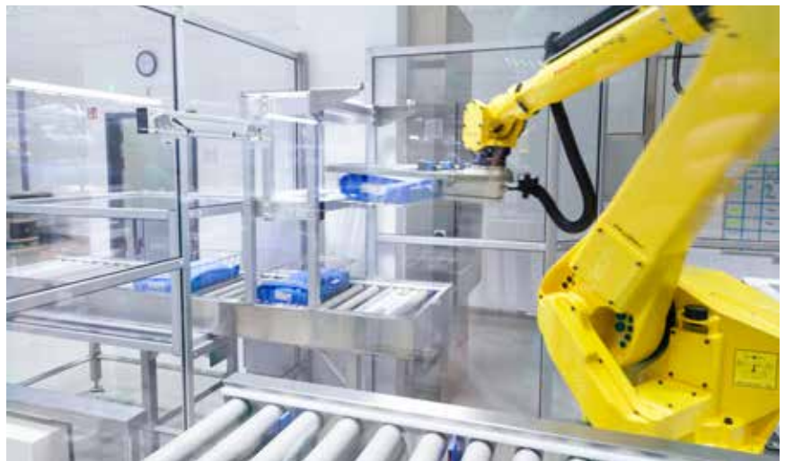
Der gelbe Packroboter stellt eine Charge für die Sterilisatoren zusammen.
