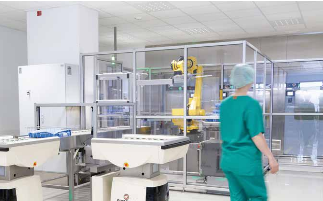
Der gelbe Packroboter stellt eine Charge für die Sterilisatoren zusammen.
